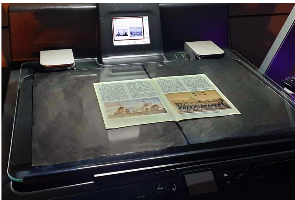
Figura 26. Uso de cartulinas negras para aislar las páginas que se están escaneando.
