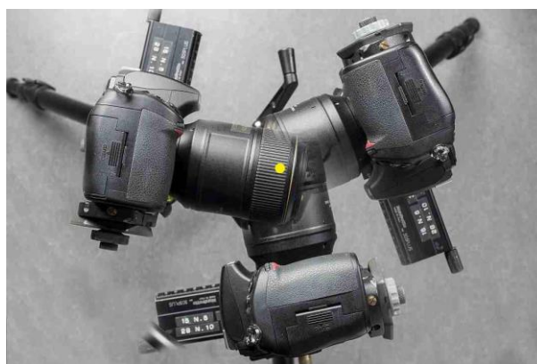
Figura 60. Giro de la cámara montada en la rótula sobre el punto nodal.
