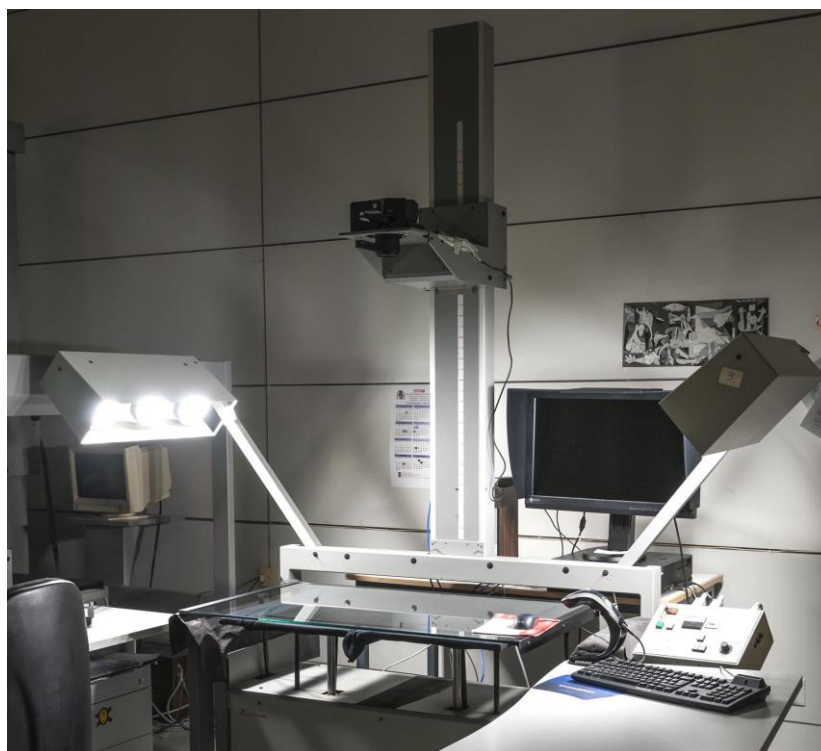
Figura 4. Microfilmadora reconvertida en escáner mediante la instalación de una cámara Nikon D810.
